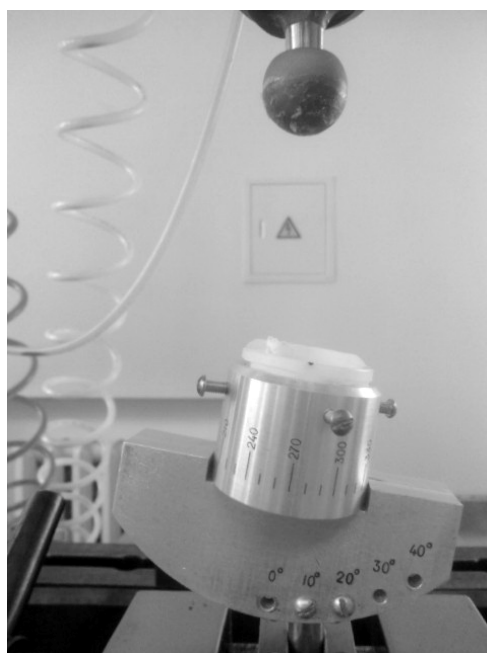
Рис. 3. Экспериментальный модуль эндопротеза тазобедренного сустава, закрепленный в универсальной испытательной машине сервогидравлического типа alter+Bay AG LFV 10-T50. Полиэтиленовый вкладыш установлен в паре трения при помощи фиксатора под углом 10 градусов.
