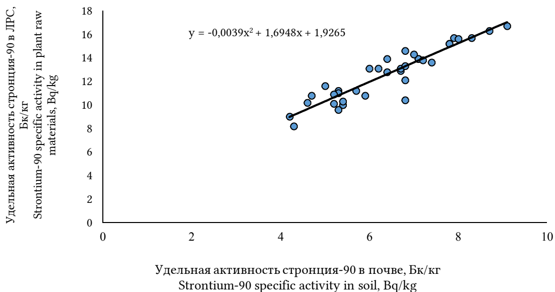
Рис. 2. Зависимость удельной активности стронция-90 в корнях лопуха большого от его удельной активности в почве.
